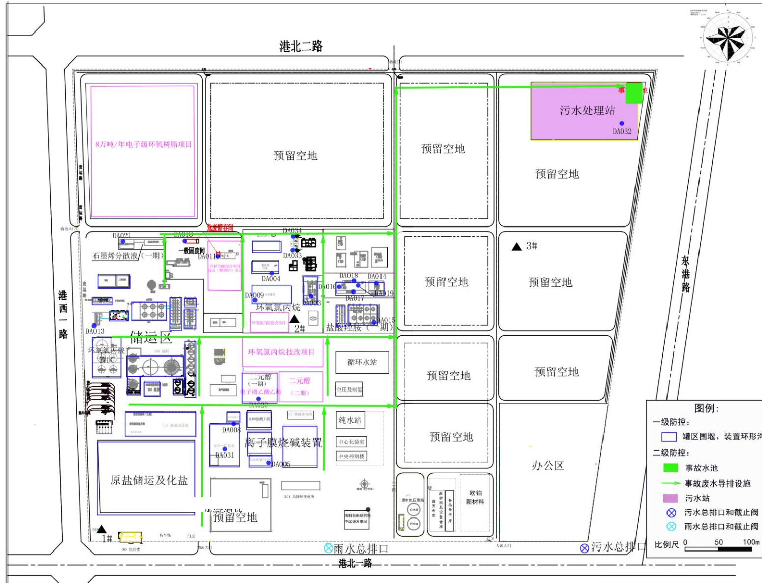
图 7.6-3 事故废水导排系统图
