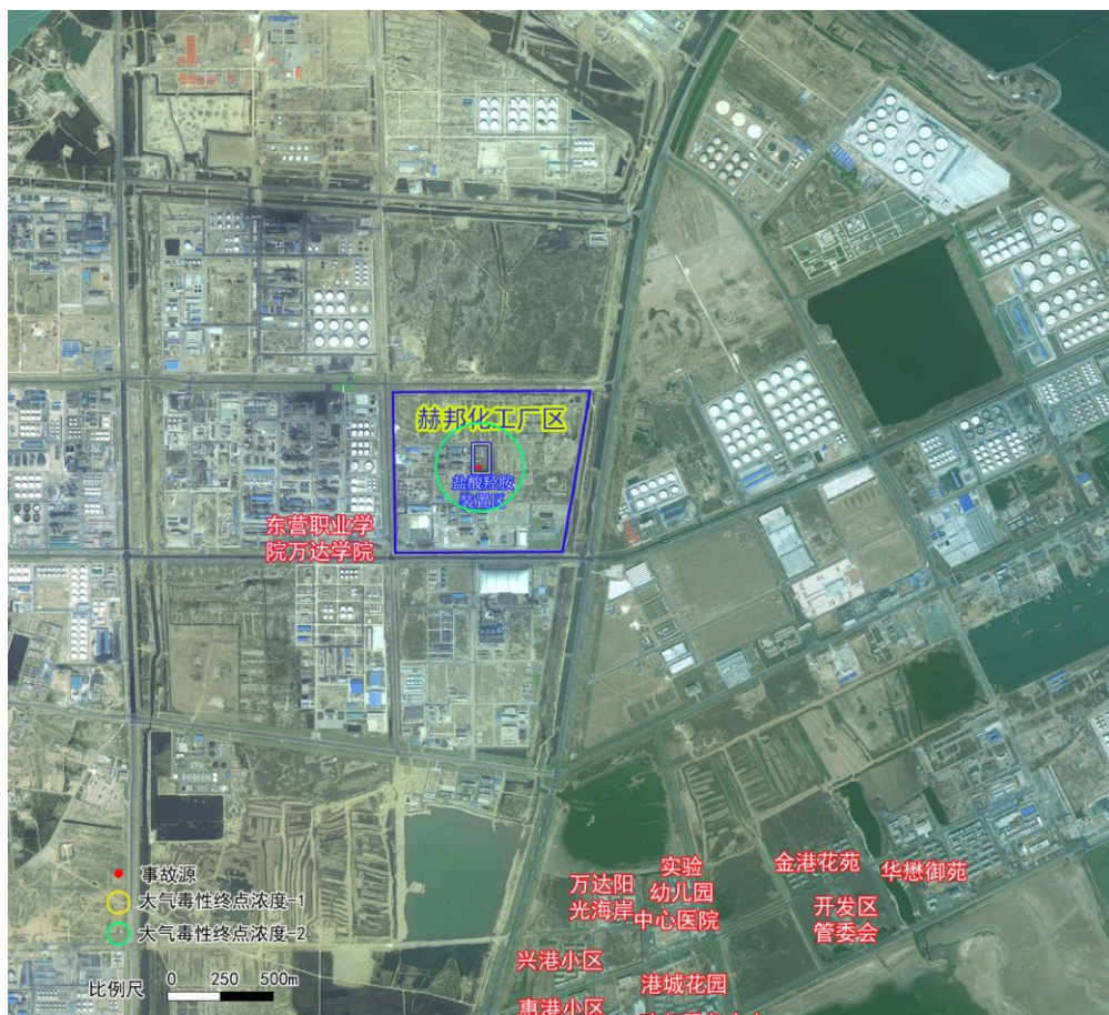
图 7.5-4 液氨储罐发生泄漏氨预测分布图（最常见气象条件）
